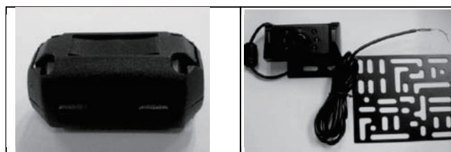
5. Ferritkern für das Kamerakabel zur Störungsunterdrückung
