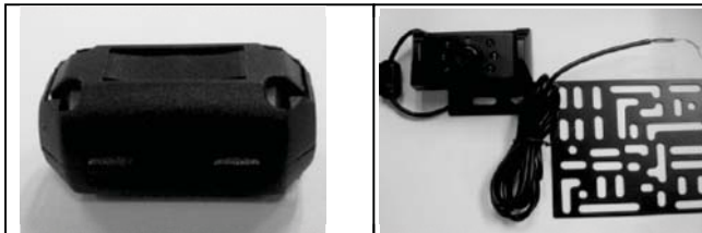
5. Ferritkern für das Kamerakabel zur Störungsunterdrückung
